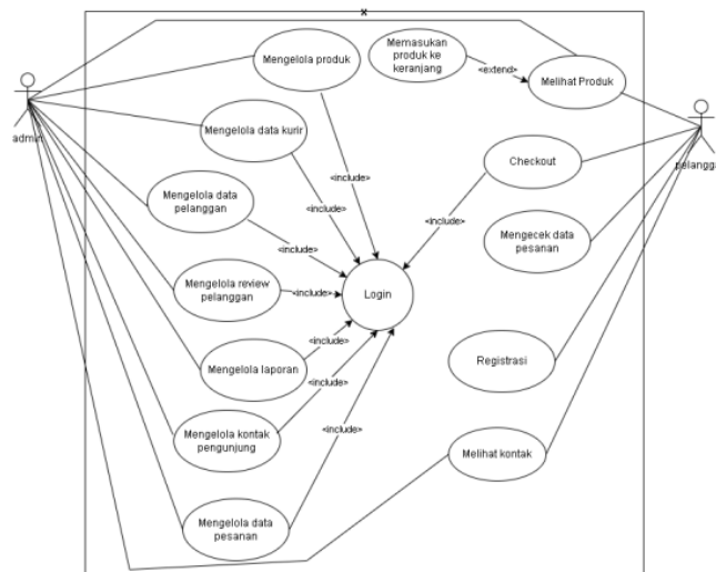
Gambar 2. Rancangan Use Case Diagram
